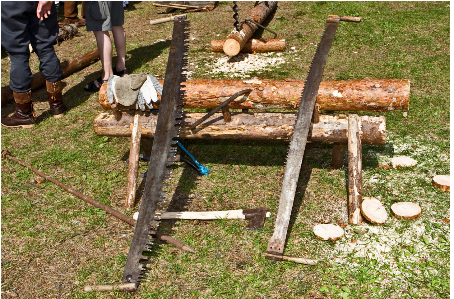
Sahapukki, hollihaka, suomalainen justeeri, sekä kanadalainen höylähammasjusteeri.
